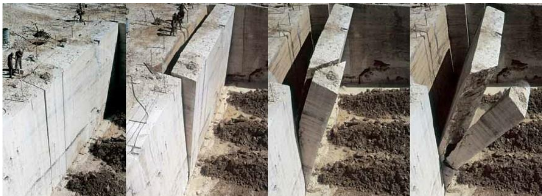
Sequenza tipo di ribaltamento di una fetta
