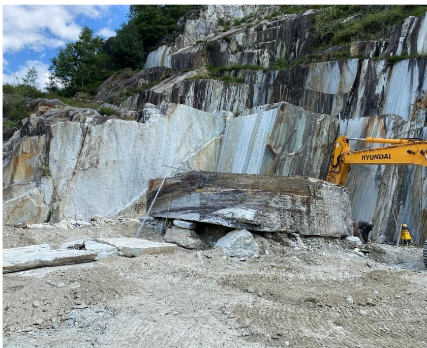
Fetta ribaltata secondo le geometrie residue delle vecchie operazioni di coltivazione; operazione successiva riquadratura con filo diamantato
